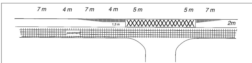
Fig. A1.3.6 - Esempio di sistemazione all'intersezione tra pista ciclabile e area di fermata dei mezzi pubblici Vejdirektorated, 1993.
