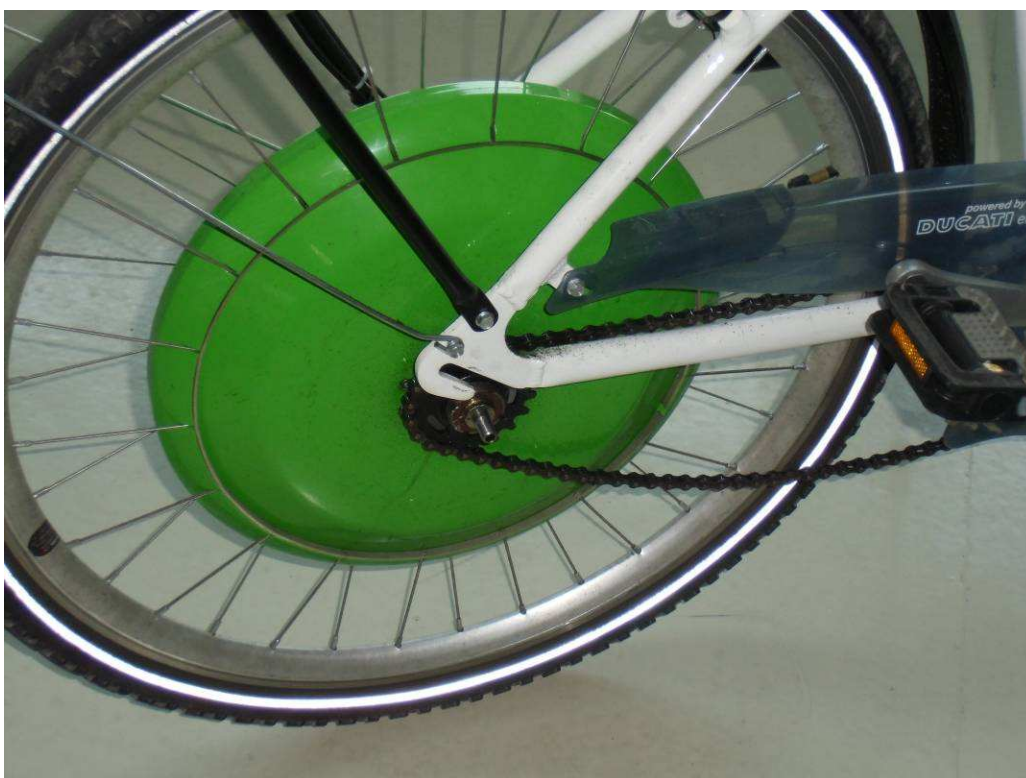
Estrarre la ruota dal drop-out del telaio.
