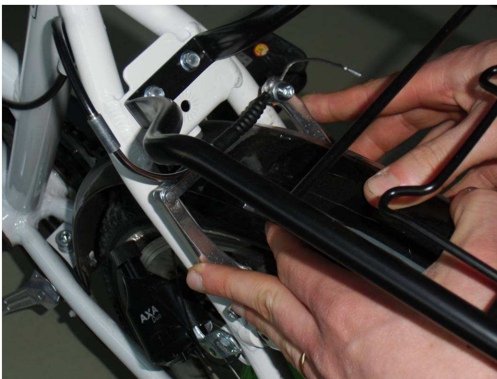
Aprire la pinza freno, altrimenti il copertone non si sfilà.
